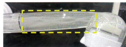
【トルネード水流可視化画像】 ※強制的に空気を送り込み流れを可視化
